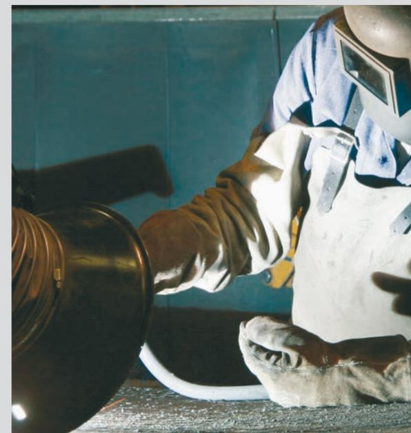
Manuelles Auftragschweißen unter Verwendung von VAUTID Stabelektroden
