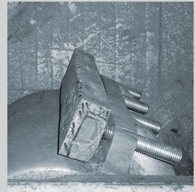
Altglasrecycling; Prallmühle zur Zerkleinerung von Keramik
